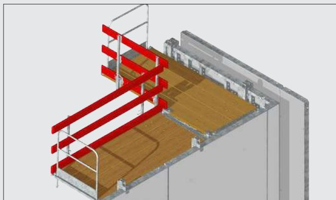
Passerelle de bétonnage rabattable pour angle avec surface de travail stable.
