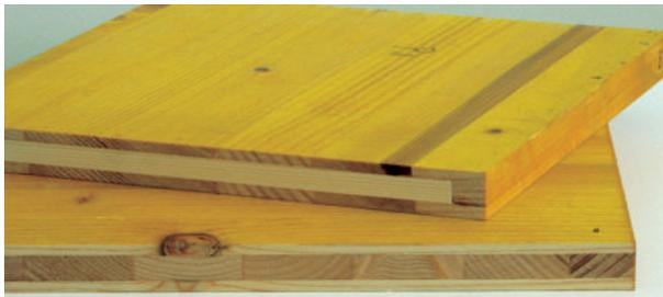
Die kreuzweise Verleimung der 3 Schichten sorgt für hohe Belastbarkeit in Längs- und Querrichtung. Handliches Format und geringes Gewicht (12.5 kg/m<sup>2</sup>) sind ideal für rationelle Einsätze aller Art.
